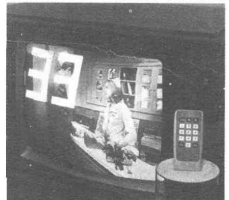
Fig. 13 - La Magnavox come indicatore di canali impiega caratteri alfanumerici che appaiono sullo schermo per alcuni secondi ogni qualvolta si cambia canale. Il selettore è a pulsanti.
