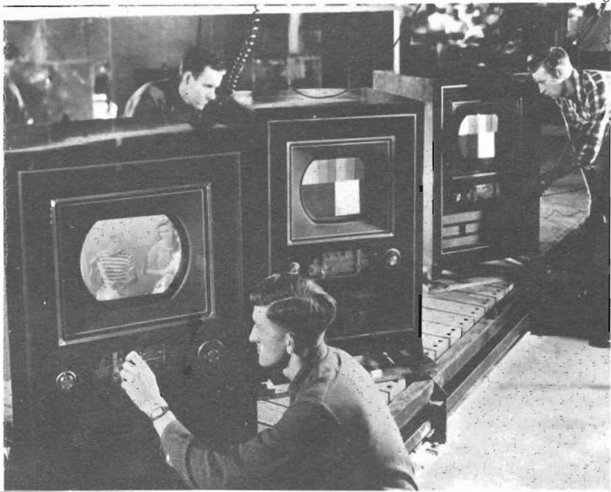
Fig. 6 - Aprile 1950 - Il Sig. Russel R. Law (a sinistra) ed il Dr. H.B. Law mentre ammirano uno dei primi ricevitori TVC completamente elettronico e compatibile con le esistenti ricezioni TV monocromatiche. Il televisore impiegava un solo cinescopio con tre cannoni elettronici ed una terna di fosfori. (vedi testo).
