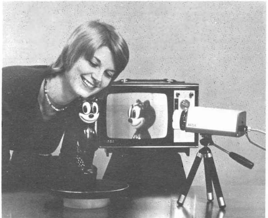
Fig. 12 - Nel 1975 l'RCA ha messo in commercio una telecamera completamente a stato solido. Il posto del tubo da ripresa è stato preso dal SID (Silicon Imagin Device). Questo è un componente creato grazie all'apporto dato dallo sviluppo del Vidicon al silicio e dell'invenzione da parte della Bell, della tecnica CCD 'Charge Coupling Device). Nella foto il vecchio Felix è stato rispolverato per dimostrare le immagini prodotte dalla telecamera impiegante un analizzatore SID il cui chip misura 7,31 x 9,75 mm. La risoluzione è di 3 MHz, mentre il costo si aggira sui $ 2.300. I SID possono essere impiegati anche per telecamere a colori.
