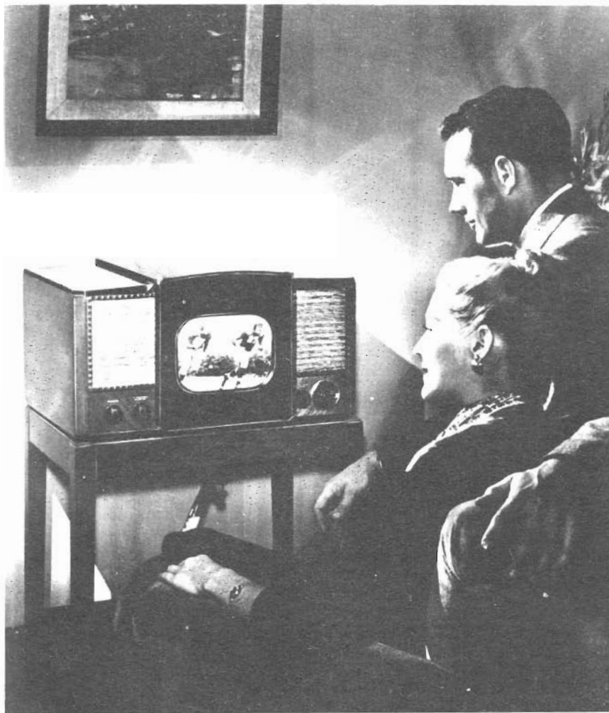
Fig. 18 - Un televisore del 1947 con cinescopio di 10 pollici e quadro di 130 centimetri quadrati. Nella foto è mostrato il modello N. 630TS che costava $350. Questo particolare televisore faceva impiego del "Eye Witness Picture Synchronizer" appena realizzato. Questa nuova tecnica permetteva una migliore stabilità dei sincronismi in tutti i 13 canali assegnati per le trasmissioni televisive.
