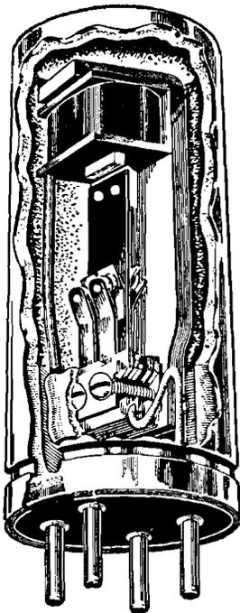
Fig. 10.5. - Parti componenti il vibratore sincrono.
