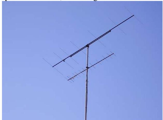
La nuova antenna l'ho realizzata con tubo di alluminio da 25 mm. recuperato da una precedente autocostruzione, dismessa. Inoltre, seguendo lo stile della famosa Fracarro, essa ha un sottoculla di irrigidimento, realizzata con lo stesso tipo di tubo, e fissata con gli originali giunti Fracarro, di recupero. Tre metri e quaranta di boom, per un guadagno di 11 dBd.
