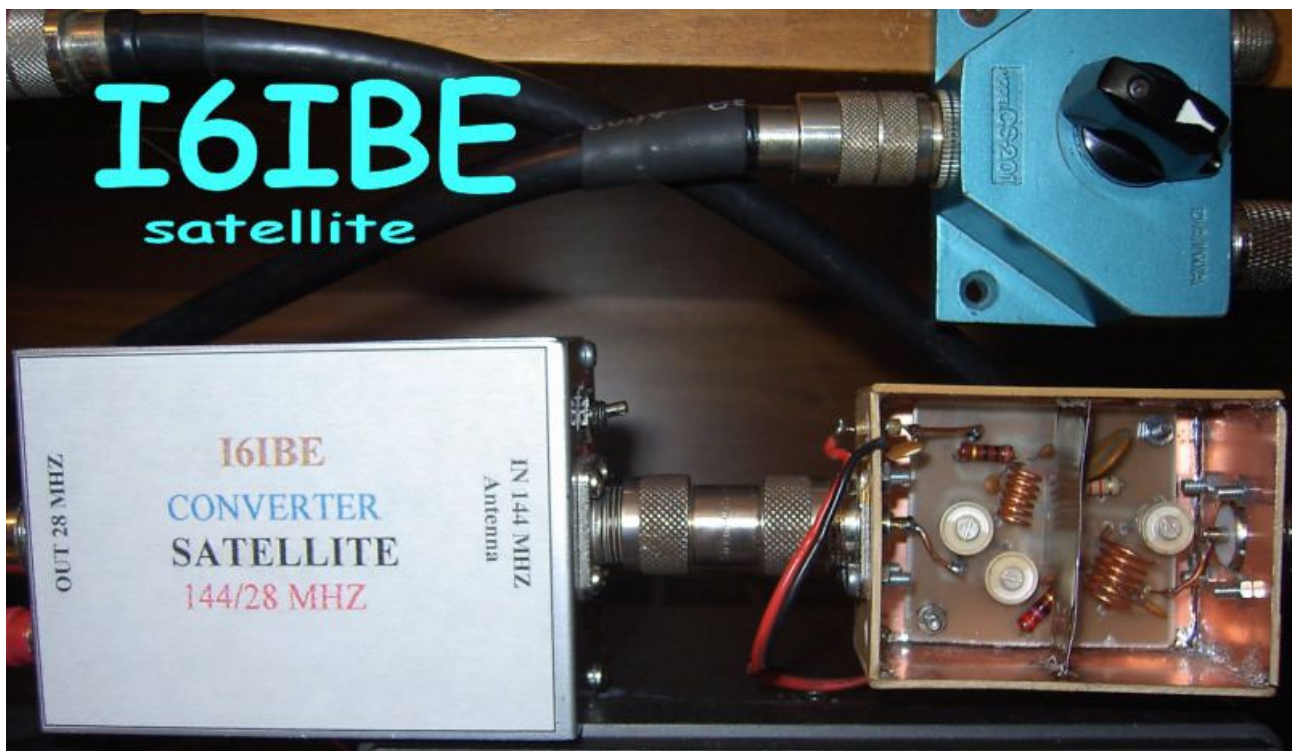
Preamplificatore collegato al CONVERTITORE 144/28 Mhz per la ricezione dei SATELLITI VO-52 e AO-29 uplink 432Mhz downlink 144Mhz. Non mi rimane che augurarvi buon lavoro, dateci giu con il saldatore, un caro saluto , ciao IVO I6IBE
