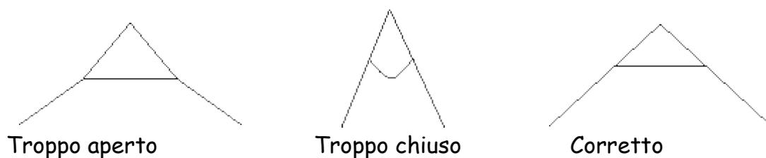
Con un analizzatore d'antenna e con l'aiuto del valente joe condor abbiamo trovato la lunghezza e apertura ottimale per il dipolo, nel mio caso sono riuscito ad avere  $R= 49$   $X=1$  con una apertura di poco più di 90 gradi, sono partito con due bracci lunghi 5,20 m per arrivare a due bracci lunghi circa 4,95m.
