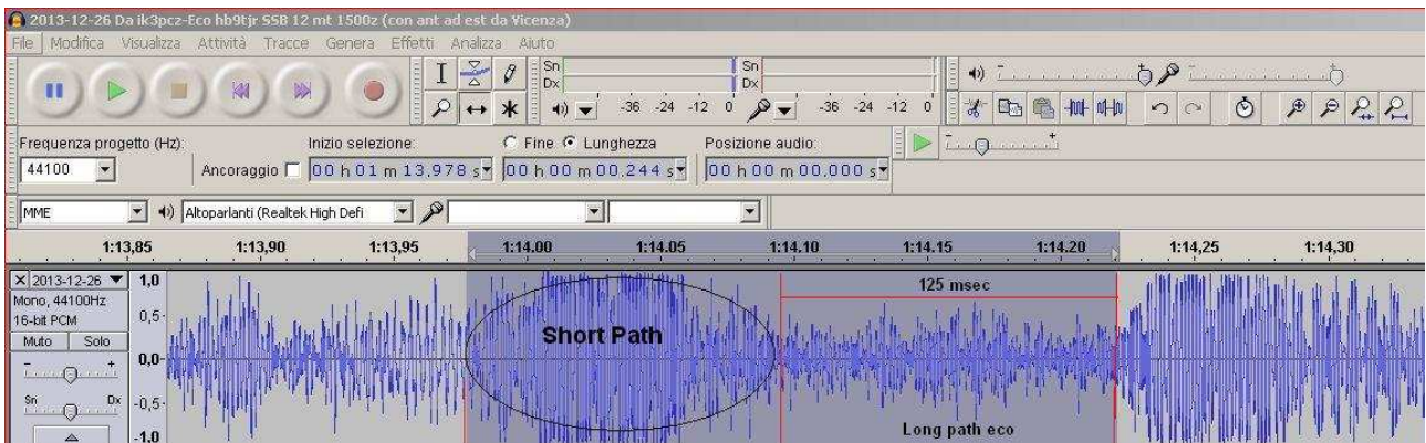
Fig.11. Analisi di una porzione di segnale di HB9TJR in 24 mhz SSB. Anche in questo caso, il segnale presenta un marcato effetto eco. (HB9TJR ascoltato da IK3PCZ con antenna a est in data 26.12.2013 ore 15.00 UTC). Credits:IK3PCZ
