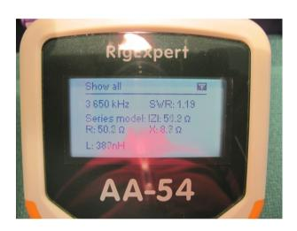
Installando la seconda versione del balun sull'antenna i risultati ottenuti rispecchiavano abbastanza fedelmente quanto rilevato sullo analizzatore, notavo inoltre con soddisfazione che la lunghezza del cavo di alimentazione non dava (come normalmente accade) grosse influenze, all'impianto.
