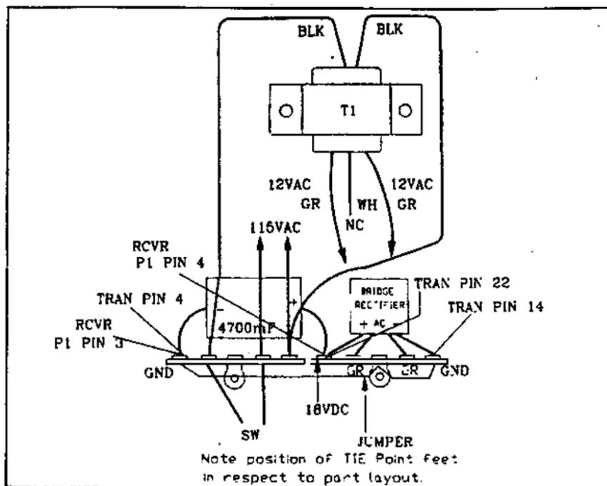
Fig. 7 Bridge Rectifier Circuit
