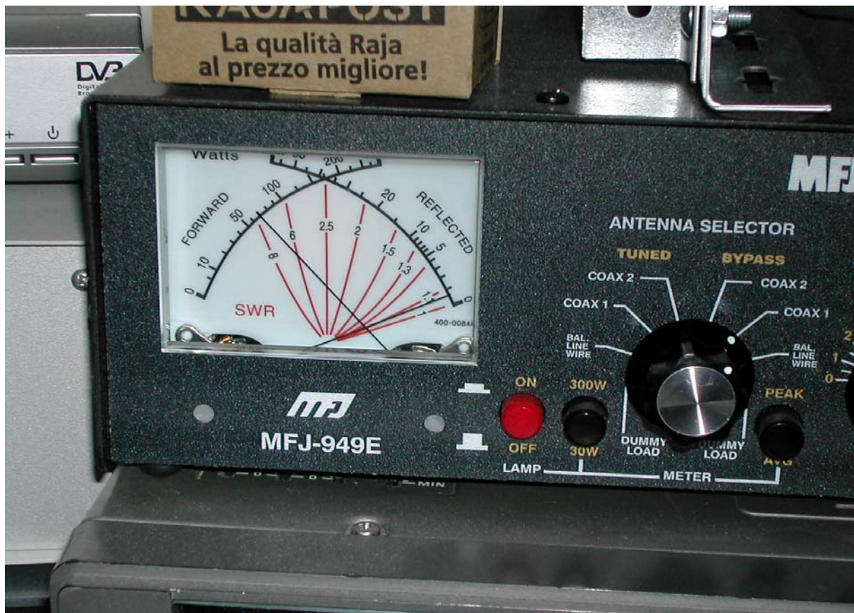
LETTURA DEL R.O.S. Sui 24940 KHz DOPO LA TARATURA
