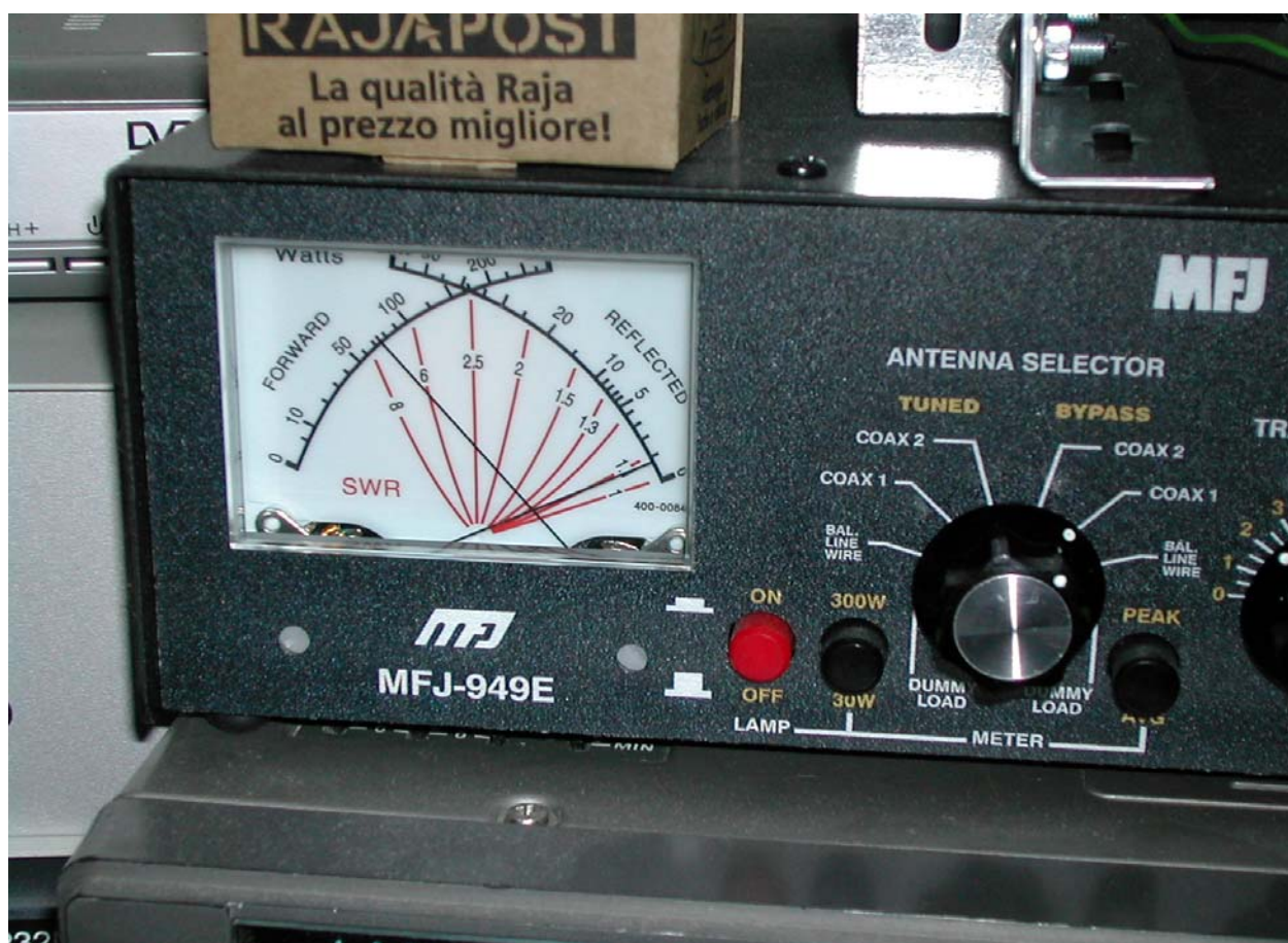
LETTURA DEL R.O.S. Sui 7.100 KHz DOPO LA TARATURA
